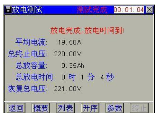
图 4-5-12 电池放电测试完成
