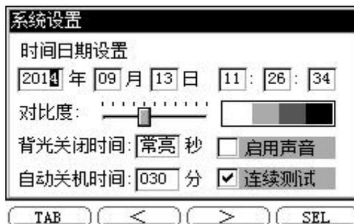
6. 按【TAB】键，移动光标到“启用声音”设置，按【SEL】键，打“√”启用语音报警，空白为关闭声音；按【TAB】键，移动光标到“连续测试”设置，按【SEL】键，打“√”启用连续测试，仪器全自动测量，空白为关闭连续测试功能；
