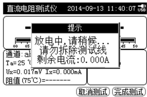
9. 仪器测试完成后，显示相应的测试结果，如果测试数据一直达不到稳定的标准，但对测试结果您已认可，则可通过按【**取消测试**】键，仪器自动放电，完成测试；
