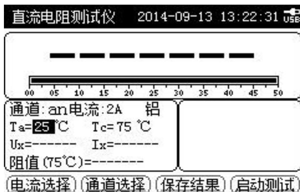
5. 完成【材料选择】后，继续按【OK】键，移动光标到 **Ta=**处，通过按显示屏右边【▲】【▼】方向键滚动选择设定实际温度，“0°C-150°C范围内可选”，仪器默认为 25°C；
