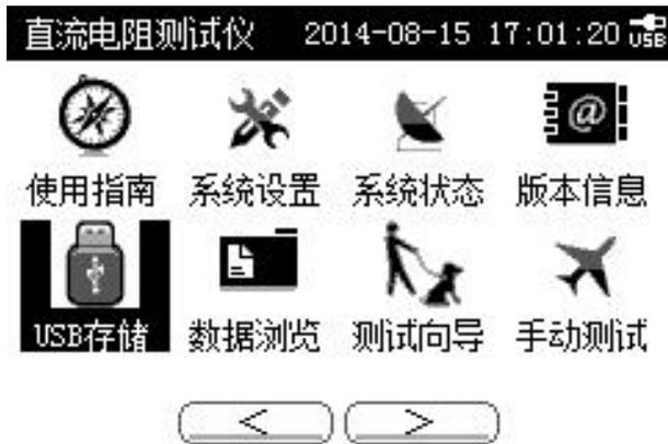
1. 将 USB 数据线将电脑与仪器连接好，回到主菜单界面，按【▲】【▼】【<】【>】键，移动光标到“USB 存储”，按【OK】键，仪器显示“USB 连接中...”
