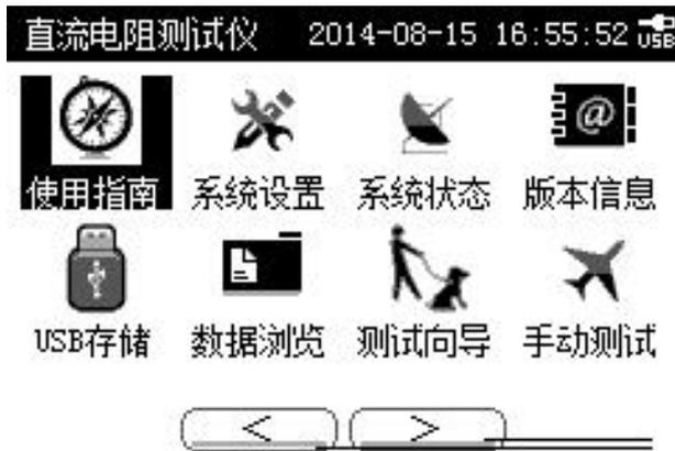
1. 按下开机键【ON/OFF】，打开仪器。按【▲】【▼】【<】【>】键移动光标到“使用指南”，按【OK】键，仪器显示“使用指南”的详细内容，通过显示屏右边【▲】【▼】方向键浏览；
