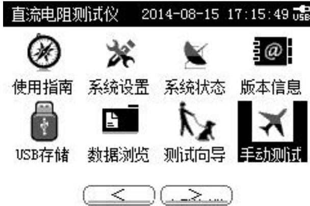
1. 回到主菜单界面，按【▲】【▼】【<】【>】键，移动光标到“手动测试”，按【OK】键进入“手动测试”界面；
